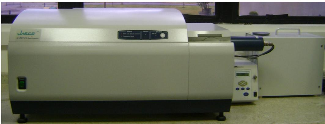
Figura 9: Imagem do espectropolarímetro Jasco J-815.
